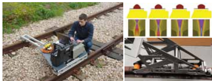
Equipamento de ACFM e de PA para dimensionar defeitos superficiais e imagens do software com indicações dos defeitos detetados.
